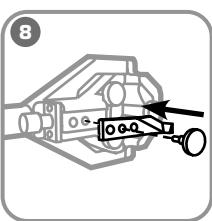
Установите нож для снятия изоляции из СПЭ.
