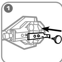
Установите нож для снятия полупроводящего слоя.
