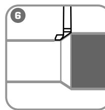
В конце движения сделайте оборот перпендикулярно оси кабеля для формирования равномерного среза.
