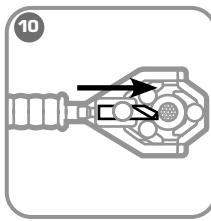
Вращая регулировочный винт, настройте нож на необходимую глубину срезаемого слоя.
