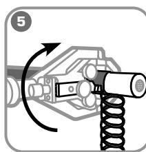
Вращая инструмент за рукоятку вокруг кабеля по спирали, снимите полупроводящий слой.
