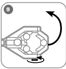
Поверните винт фиксации откидной планки. Откиньте планку, установите кабель в инструмент, закройте планку и зафиксируйте винтом.
