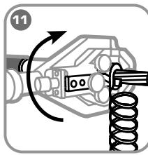
Вращая инструмент за рукоятку вокруг кабеля по спирали, снимите изоляцию на необходимую длину.
