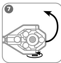
Поверните винт фиксации откидной головы, и снимите инструмент с кабеля.
