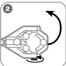
Поверните винт фиксации откидной планки (только для КСП-65). Откиньте планку, установите кабель в инструмент, закройте планку и зафиксируйте винтом.
