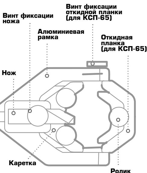
Инструмент комплектуется двумя видами ножей, один из них - нож для снятия полупроводящего слоя, другой - для снятия слоя изоляции из свитого полиэтилена (СПЭ). Кабель размещается в рабочей зоне инструмента, нож устанавливается на необходимую, допустимую глубину, после чего инструмент вращается на роликах вокруг оси кабеля. Инструмент КСП-65 имеет откидную рабочую голову, что позволяет упростить установку кабеля в рабочей зоне
