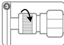
**3** Плотно затяните гильзу БРС, приложив достаточное усилие (от руки) для обеспечения хорошего соединения (без применения слесарного инструмента)
