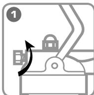
**Установите помпу под углом 30° заливной пробкой вверх. Произведите установку ножной педали в рабочее положение и ослабьте винт для стравливания воздуха.**
