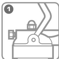
**Установите помпу вертикально, заливной пробкой вверх.**
