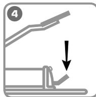
**4** После завершения рабочего цикла сбросьте давление, нажав на «ножной рычаг принудительного сброса давления»
