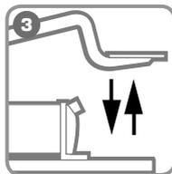
**3** Нагнетайте давление педалью до завершения операции (при опрессовке - смыкание матриц, при резке - полное перерезание кабеля или до срабатывания АСД)
