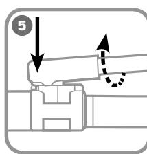
Для сброса давления поверните подвижную рукоятку и надавите ей на толкатель клапана сброса давления
