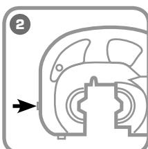
Установите ответную матрицу в пазы верхней части рабочей головы и зафиксируйте винтом
