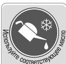
Во время подготовки инструмента к эксплуатации убедитесь, что используемое гидравлическое масло соответствует температуре окружающей среды в месте проведения работы. Проверьте наличие и уровень масла в резервуаре инструмента
